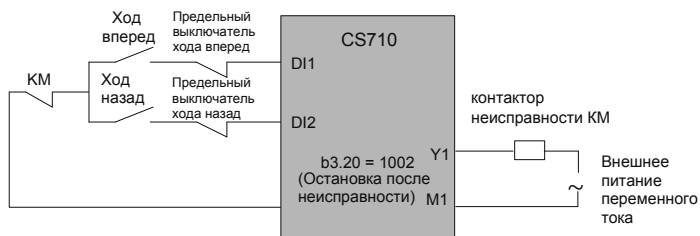
Рис. 5-10. Контур ограничителей безопасности и остановки после неисправности
