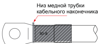
Рис. 3-36 Термоусаживаемая трубка, закрывающая провод кабеля
