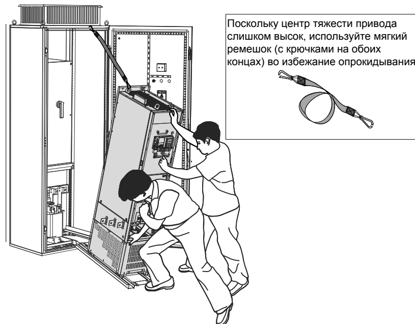
Рисунок 2-18 Вкатывание привода в шкаф
