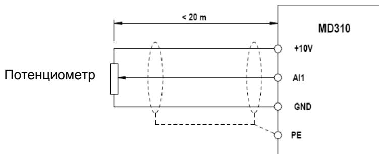
В системах, где аналоговые сигналы подвергаются воздействиям сильных внешних помех, установите фильтрующий конденсатор или ферритный магнитный сердечник у источника аналогового сигнала.
