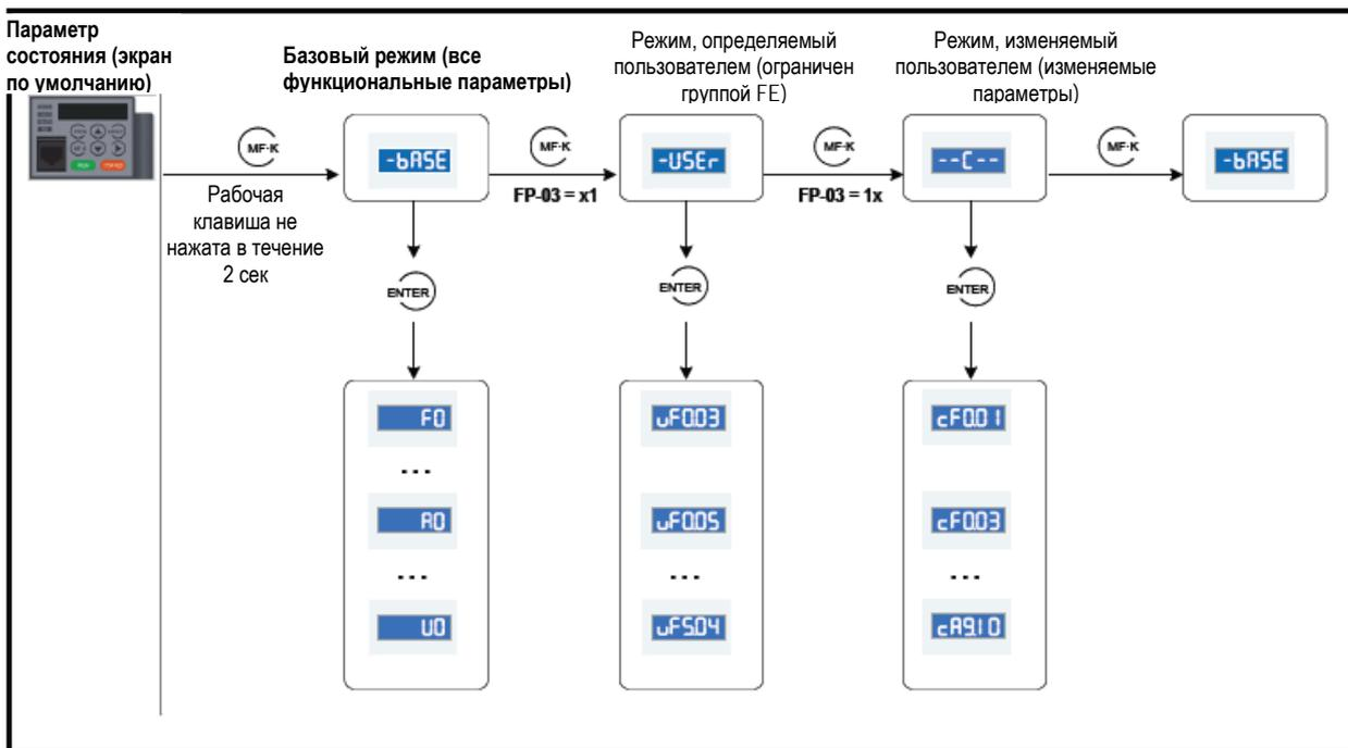
Величина, которую вы задаете для функционального параметра FP-03, определяет, воспроизводит ли рабочая панель функциональные группы быстрого просмотра, определяемые пользователем, и быстрого просмотра, изменяемые пользователем. Базовый режим всегда доступен.
