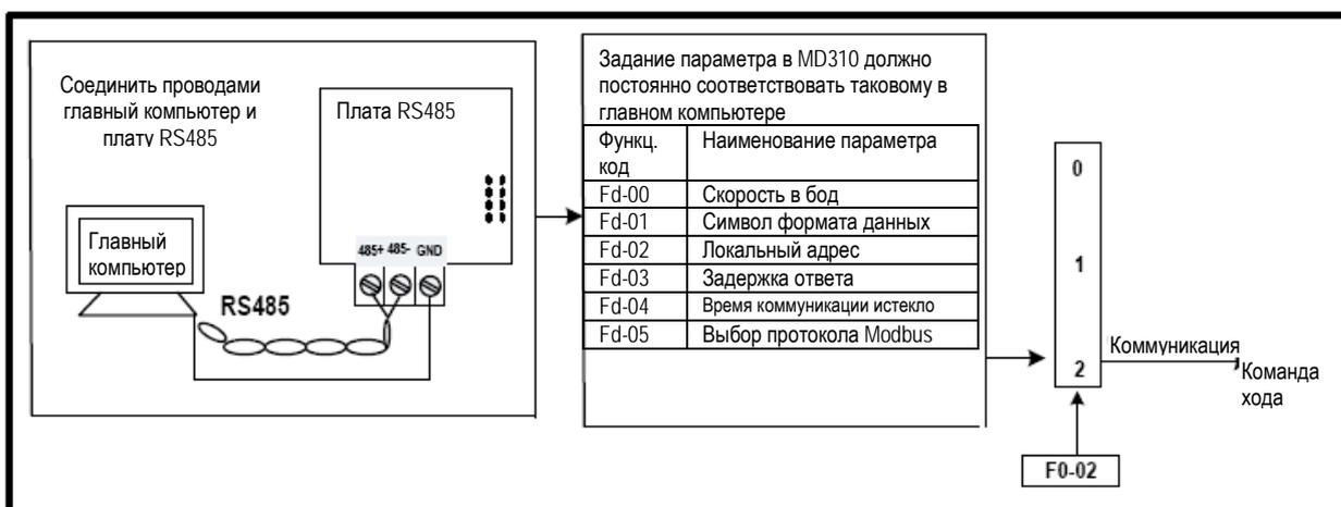
Когда функциональный параметр Fd-04 задан на величину, отличную от нуля, MD310 автоматически останавливает систему привода, если время коммуникации истекло. Это предохранительная функция, которая предотвращает непрерывную и бесконтрольную работу привода переменного тока, когда случается ошибка в кабеле связи или в управляющем компьютере.
