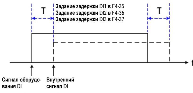
Десять клемм DI могут быть определены в функциональных кодах F4-00 – F4-09. Каждому DI может быть присвоена функция, одна из 50. Более подробно см. описания с F4-00 по F4-09.
