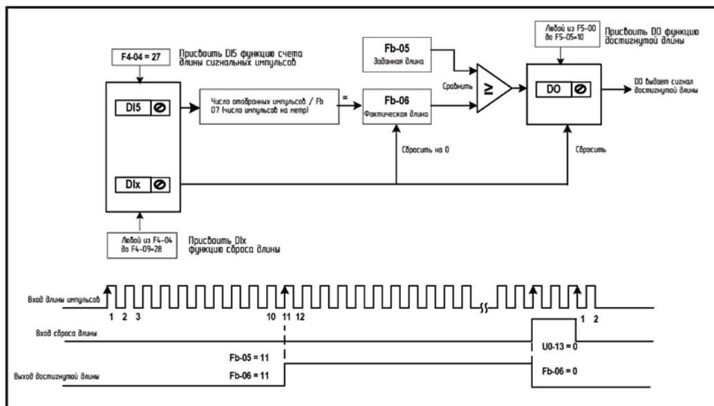
В режиме контроля фиксированной длины направление определить нельзя, можно только вычислить длину исходя из числа импульсов.
