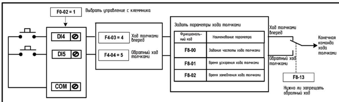
Задать параметры в соответствии с 5-19. В состоянии остановки привода нажать кнопку FJOG. После этого привод переменного тока начинает движение толчками. После того как кнопка FJOG отжата, привод переменного тока замедляется и останавливается. Кнопка RJOG используется для задания движения толчками в обратном направлении.
