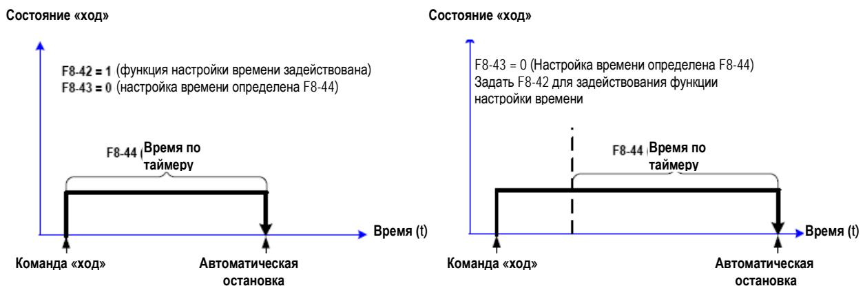
Вы можете задать продолжительность настройки времени по таймеру с помощью аналогового входа (например, сигнал потенциометра). Более детально – см. описание F8-43.
