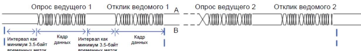
Протокол связи, используемый приводом это протокол связи ведомого Modbus-RTU, который позволяет приводу отправлять данные на отклик "запрос/команда" от ведущего или выполнить действие в соответствии с "запрос/команда" от ведущего.
