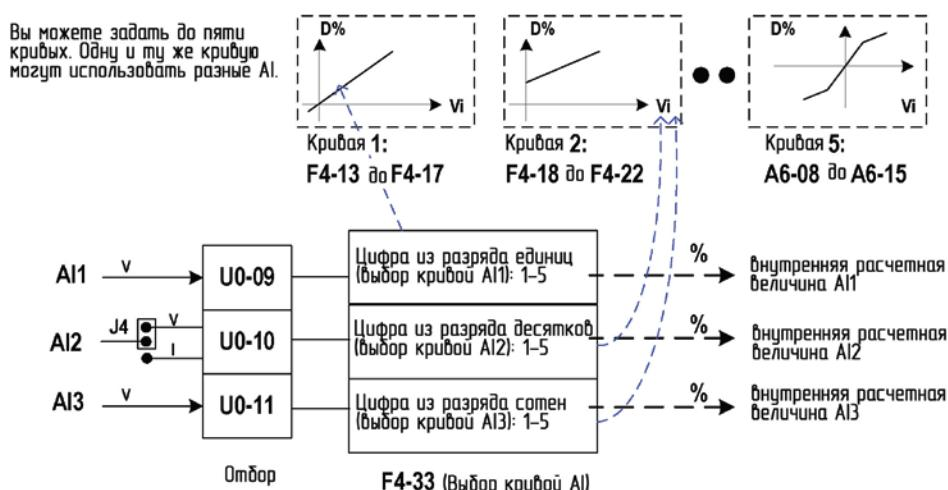
Отбор клемм AI можно наблюдать в U0-09 – U0-11. Расчетная величина – для последующего внутреннего расчета и не может напрямую считываться пользователем.
