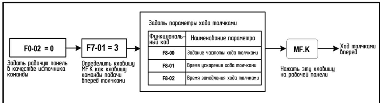
Задать параметры в соответствии с рис. 5-18. В состоянии остановки привода нажать кнопку MF.K. Далее привод переменного тока запускается в режим работы толчками. Если вы отпустите кнопку MF.K, привод переменного тока замедляется и останавливается.
