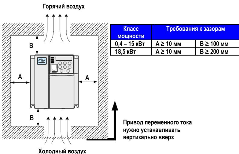
Привод переменного тока серии MD310 рассеивает тепло снизу вверх. Если нужно, чтобы вместе работали несколько приводов переменного тока, устанавливайте их бок о бок.
