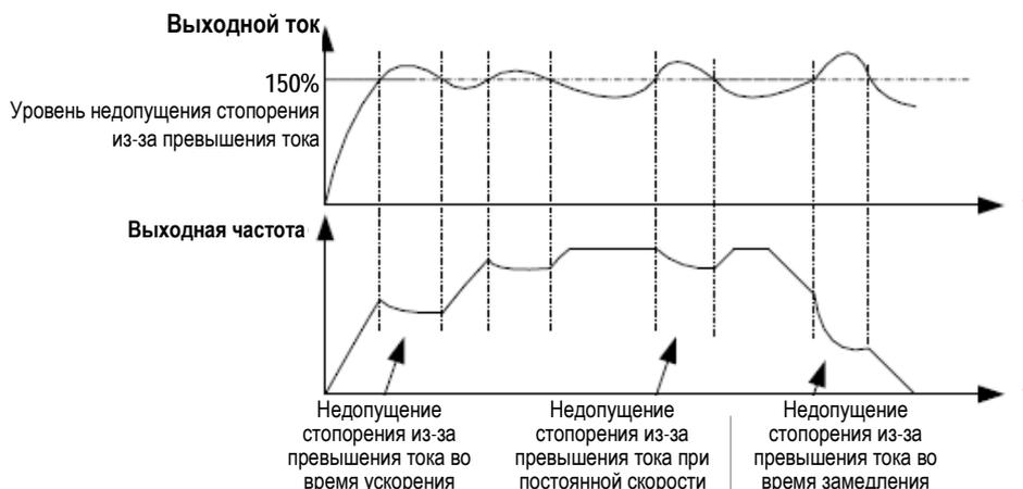
В зоне высокой частоты ток привода двигателя небольшой, и в сравнении с частой ниже номинальной ток стопорения вызывает большее падение скорости двигателя. Чтобы улучшить ходовые характеристики двигателя, вы можете снизить уровень недопущения стопорения из-за превышения тока выше номинальной частоты.
