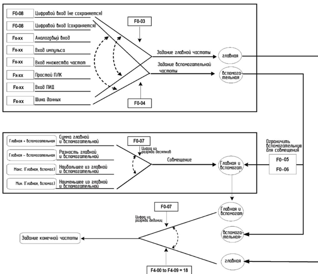
Совмещение между главной и вспомогательной может использоваться для управления скоростью в замкнутом контуре. Пример этого – использование главной для задания нужной частоты и использование вспомогательной для автоматической настройки. Управление в замкнутом контуре осуществляется, когда этот метод используется с переключением, выполняемым сигналом на клемму внешнего цифрового выхода.
