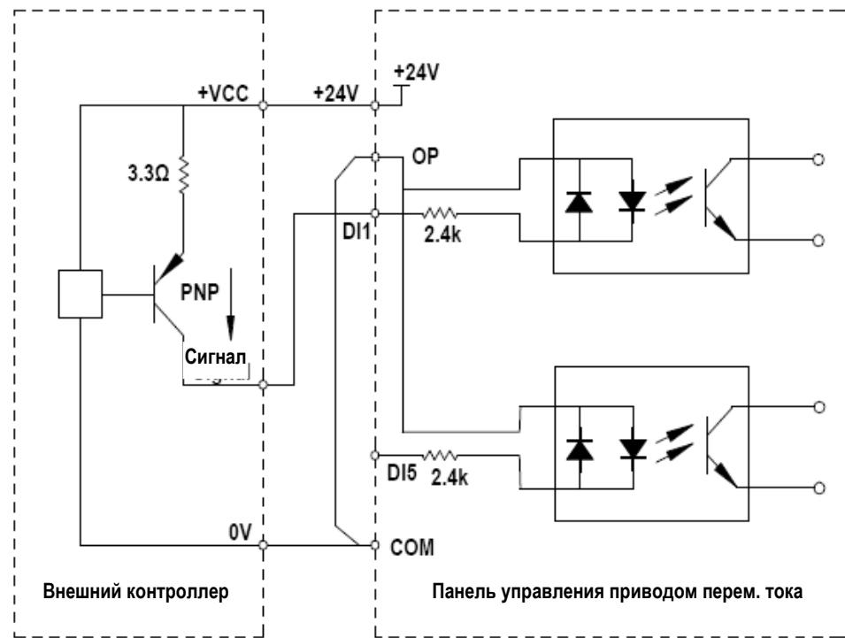
Для использования режима проводки SOURCE, подсоедините клемму OP к клемме COM с J7 и подсоедините +24V к соответствующему клемме DI через контакт на внешнем контроллере.
