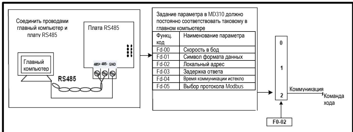
Когда функциональный параметр Fd-04 задан на величину, отличную от нуля, MD310 автоматически останавливает систему привода, если время коммуникации истекло. Это предохранительная функция, которая предотвращает непрерывную и бесконтрольную работу привода переменного тока, когда случается ошибка в кабеле связи или в управляющем компьютере.
