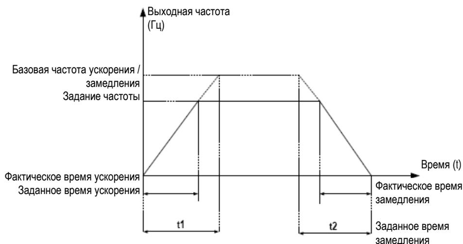
Всего MD310 обеспечивает на выбор четыре группы времени ускорения/замедления. Переход можно выполнить, используя клемму DI.
