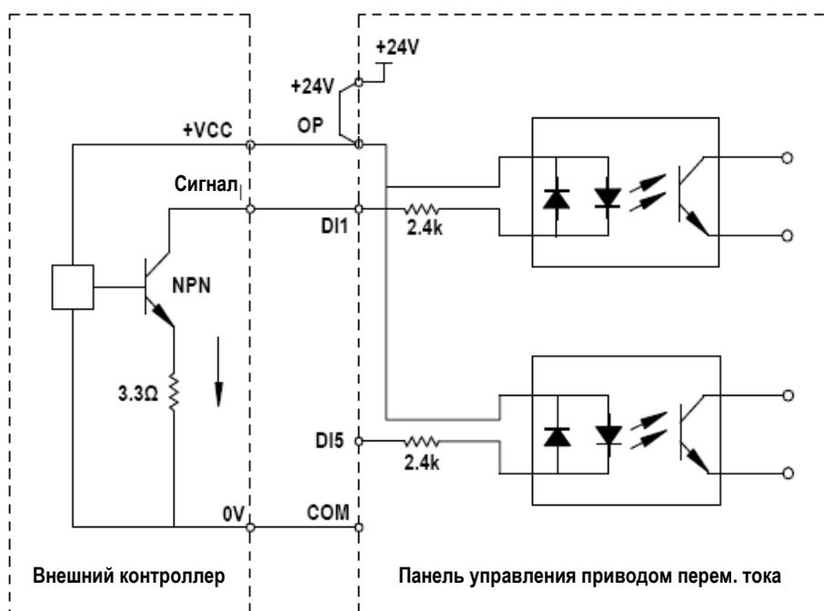
Режим SINK чаще всего используется в режиме проводки. Он также является режимом проводки по умолчанию, в котором закорачиваются клеммы +24V и OP.
