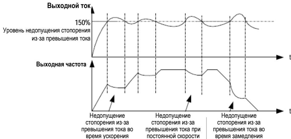
В зоне высокой частоты ток привода двигателя небольшой, и в сравнении с частотой ниже номинальной ток стопорения вызывает большее падение скорости двигателя. Чтобы улучшить ходовые характеристики двигателя, вы можете снизить уровень недопущения стопорения из-за превышения тока выше номинальной частоты.
