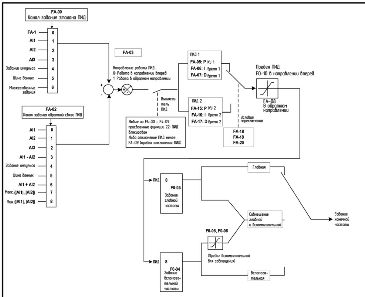
При использовании ПИД-управления замкнутым контуром частоты функциональный код F0-03 (выбор канала задания главной частоты) должен быть установлен на величину 8 (ПИД). Относящиеся к ПИД параметры заданы в группе FA, как показано на рис. 6-8.
