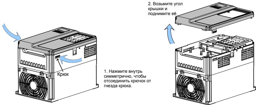
Рис. 3-12 Снятие передней крышки ME320LN (металлический корпус)
