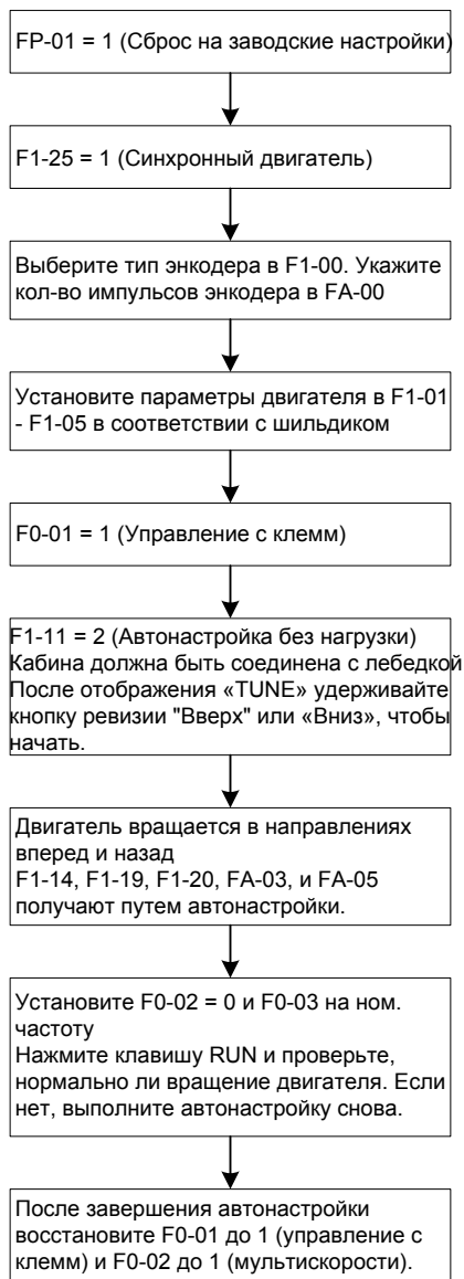
Рис. 7-3 Последовательность автонастройки без нагрузки синхронного двигателя
