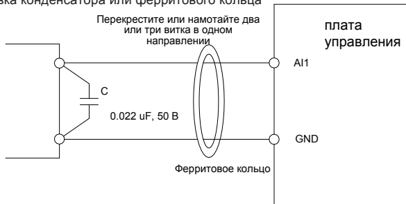
Рис. 3-18 Установка конденсатора или ферритового кольца
