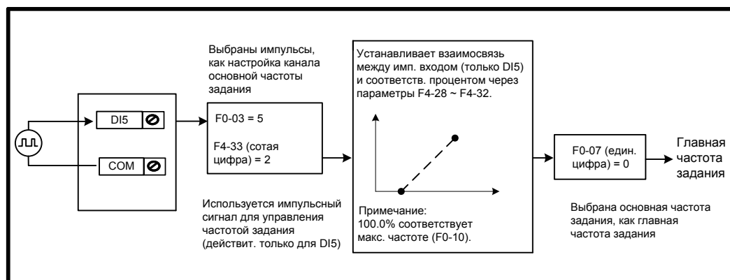
Рисунок 6-19 Настройка импульсного входа DI5 для управления частотой задания
