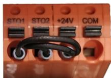
В отличие от предыдущих серий, MD520 получил встроенные клеммы **STO SIL3** для реализации функции безопасного останова, встроенную свободно программируемую логику с помощью которой пользователь может создать требуемую ему программу управления приводом без участия контроллера, а также ряд дополнительных функций, например, ведущий-ведомый.
