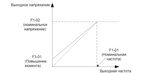
**СТАБИЛЬНАЯ РАБОТА ПРИ ПРОВАЛАХ НАПРЯЖЕНИЯ**
